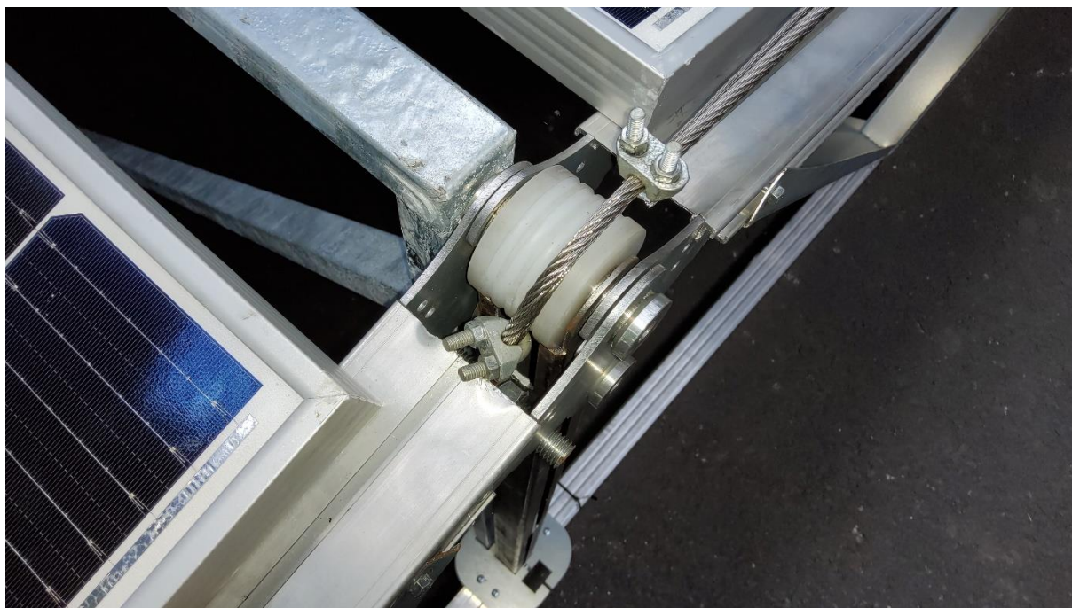
Afb. 2 Proefopstelling staalkabel verbinding.
